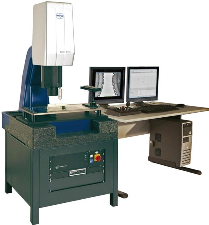
ScopeCheck 配置變焦光學 Werth ZOOM 系統。允許用戶選擇放大倍率，還可以調整工作距離，以實現深孔或大直徑圓柱形工件的無碰撞量測
