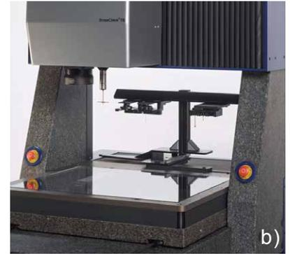
適用於任何應用的 WMS Multisensor 多測頭更換技術採用新的 transmitted light concept
