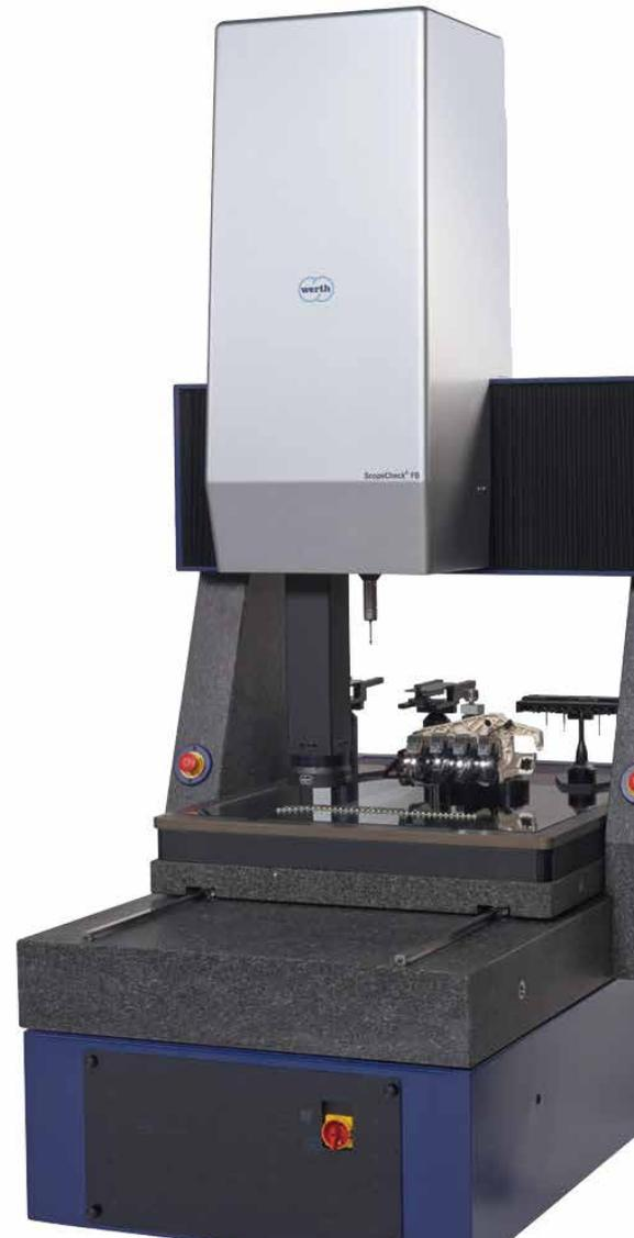
德國 Werth VideoCheck、ScopeCheck、TomoScope CT 量測儀，
